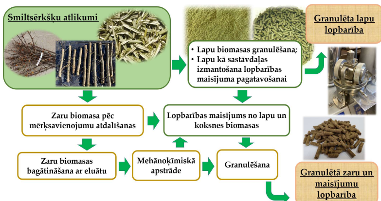
17. att. Ilgtspējīgas smiltsērķšķu atlikumu pārstrādes shēma lopbarības granulu iegūšanai
