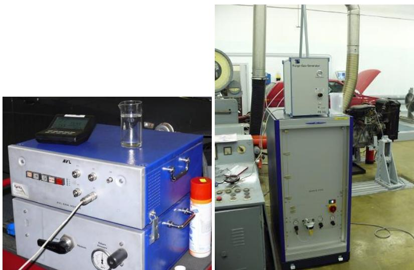
**2.5. att. Degvielas patēriņa mēriekārtā *AVL KMA Mobile* un atgāzu analītiskā sistēma *AVL SESAM FTIR***
