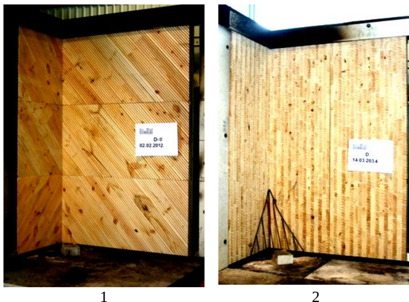
3.14. att. Koksnes šūnveida materiāla virziens vienotās dedzināšanas pārbaudes iekārtā:
