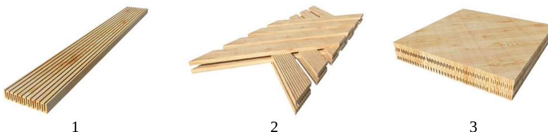
1.3. att. Četru kārtu KŠM izgatavošanas princips 4 :
