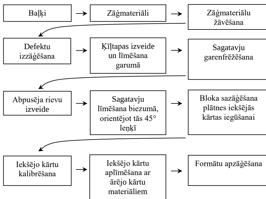
1.2. att. Dendrolight ® trīs kārtu plātņu izgatavošanas tehnoloģijas principiālā shēma.
