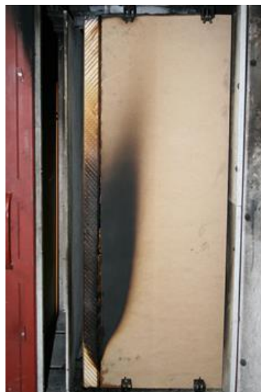
4.4. att. SBI pārbaude 60 mm bieziem 3 kārtu prototipiem ar HDF plātnēm ārējās kārtās.
