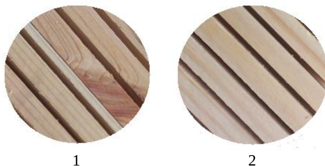
3.11. att. Ūdens tvaika pārvades raksturlielumu noteikšanas paraugu virsmu atšķirība: 1 - ar divām blakus novietotām lamelēm; 2 - ar vienu lameli iedarbei pakļautā laukuma platumā.
