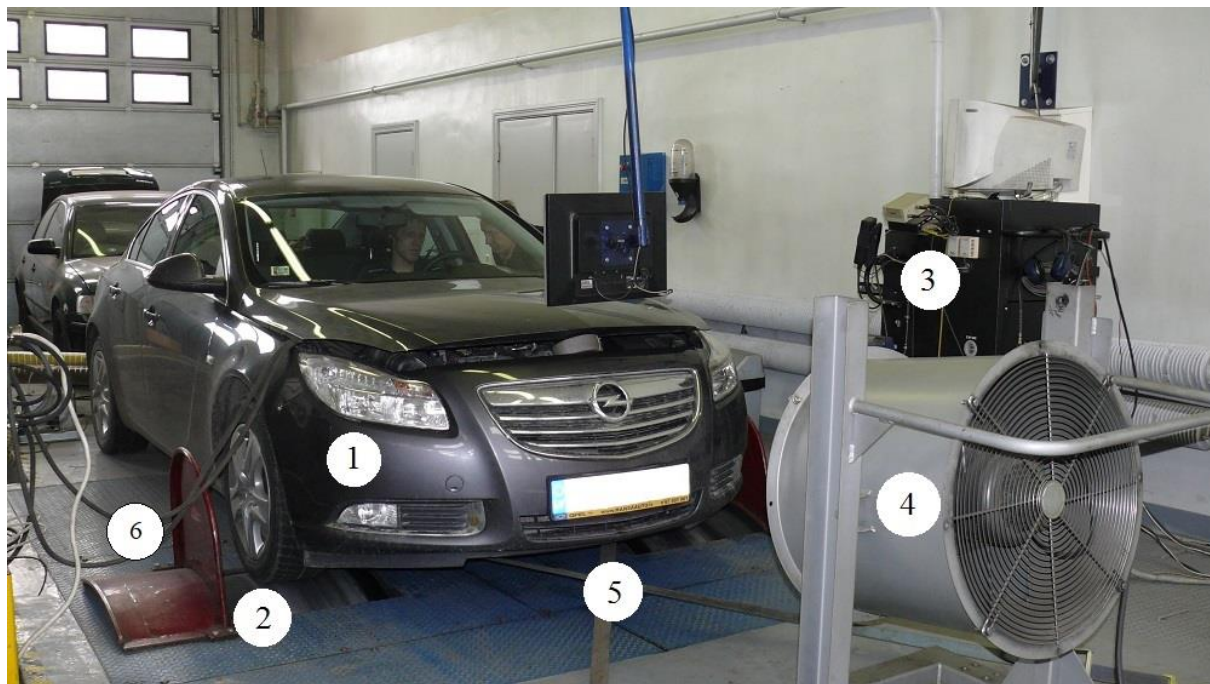
2.6. att. Uz jaudas stenda Mustang MD – 1750 nostiprināts testējamais automobilis
