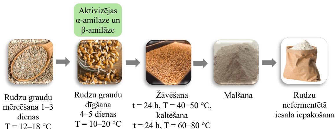
1.4. att. Rudzu nefermentētā iesala gatavošanas tehnoloģija / Fig. 1.4. Technology for the Preparation of Unfermented Rye Malt (Bera et al., 2018; Wang et al., 2018)
