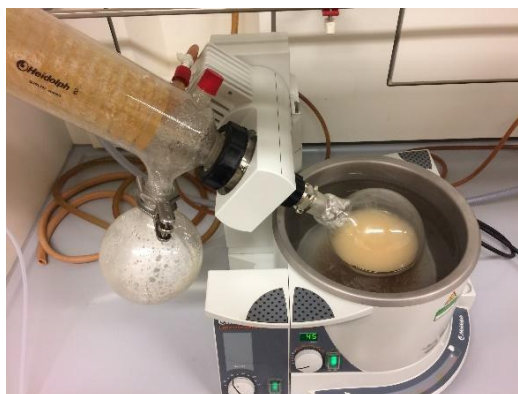
Fig. 2.5. Rotary evaporator Heidolph Laborota 4000 Efficient / 2.5. att. Rotācijas ietvaicētājs Heidolph Laborota 4000 Efficient
