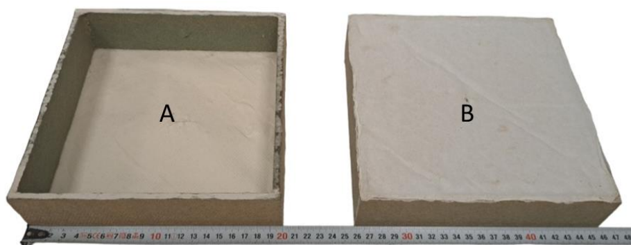
2.4.att. Izgatavotā beramā siltumizolācijas materiāla forma, siltumvadītspējas un siltumnerces noteikšanai
