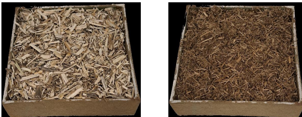
2.5.att. Izstrādātais kaņepju spaļu izolācijas materiāls
