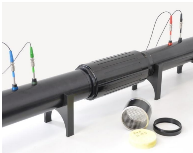
2.8. att. Pilnās pretestības skaņas izolācijas mērīšanas iekārta AcoustiTube AED (Aucoustic Engeneering Dresden) attēls
