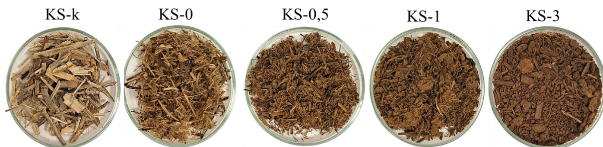
3.1. att. Kaņepju spaļu paraugs pirms un pēc TS
