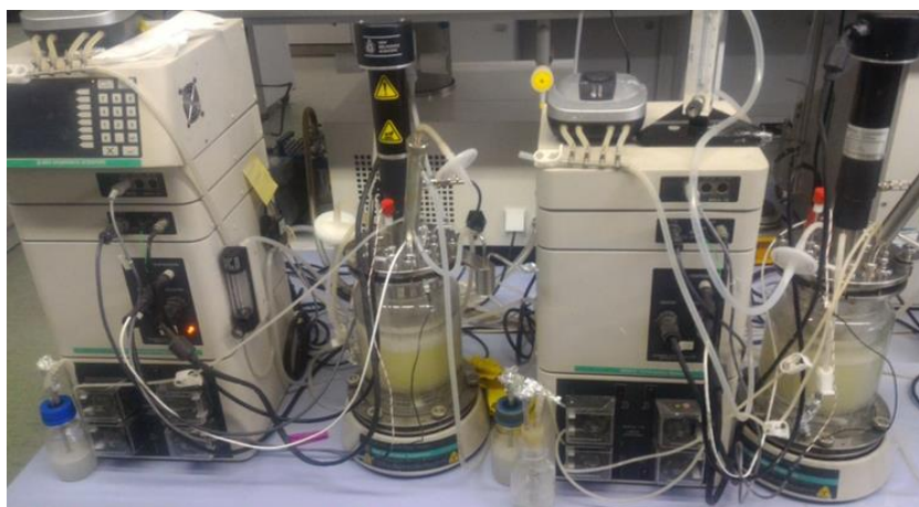
2.6. att. Fermentācijas process bioreaktoros (Bio Flo 110, New Brunswick Scientific, ASV) / Fig. 2.6. Fermentation in bioreactors
