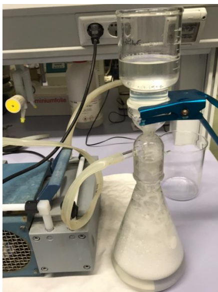
2.7. att. Mikrofiltrācijas process / Fig. 2.7. Process of microfiltration
