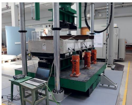
Plānsienu sendvičtipa sienu panelu izpēte U- Skadiņa zinātniskajā projektā "Šķiedrbetona efektivitāte nesošo sienu konstrukcijās" (avots: BKZL arhīvs)
