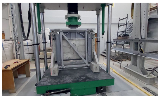
Dobo plātņu balstījuma pārbaude bīdē pēc SIA "Dzelzsbetons MB" pasūtījuma. (avots: BKZL arhīvs)
