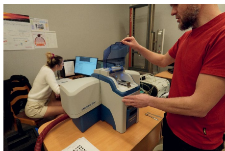
Darbs Būvmateriālu laboratorijā ar daļiņu analizatorā Microtrac FLEX
