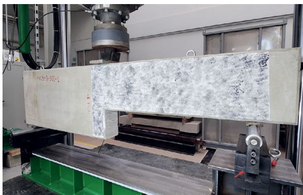
Paraugs slogojumā Solvitas Šņores maģistra darbā Šķiedru ietekme uz dzelzsbetona siju darbību bīdes slogojumā (avots: autores arhīvs).
