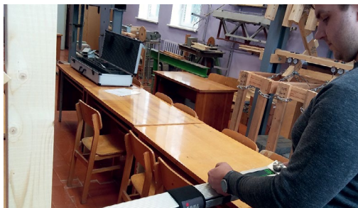
Doktorants Jānis Fabriciuss izmēģina rezistografu koksnes blīvuma noteikšanai (avots: Būvkonstrukciju katedras arhīvs)
